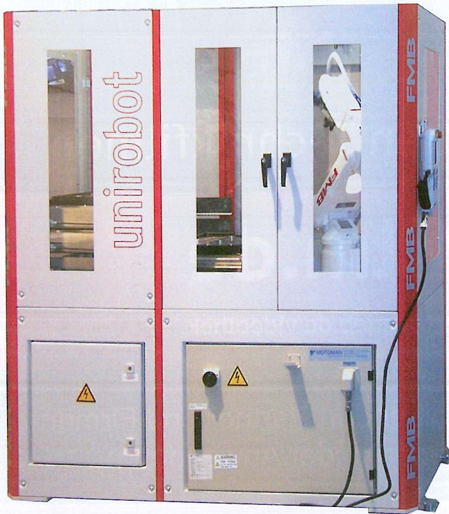
1 Die universelle Automationszelle FMB Unirobot MH 5L-5P integriert bei einer Stellfläche von lediglich 1800×900 mm 2 einen 6-achsigen Industrieroboter von Motoman sowie ein Palettenmagazin für bis zu fünf jeweils 600×400 mm 2 große Werkstückträger
