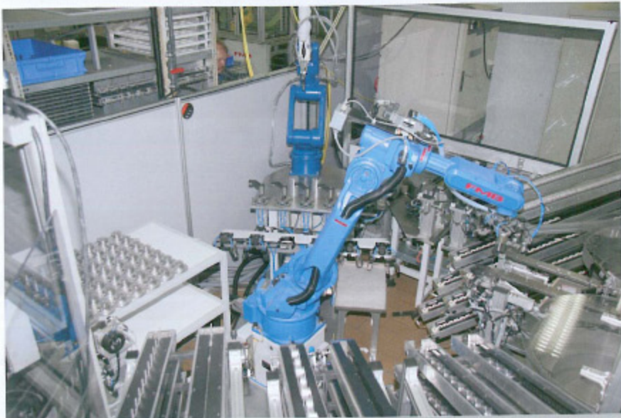
Bild 2: Der FMB „Automationsbaukasten“ UNIROBOT lässt sich durch anwenderspezifisch anpassbare Zuführ- und Palettiersysteme sowie flexibel gestaltbare Greifer, -Magazine und -Wechsel-einrichtungen vielseitig einsetzen. Das Anwendungsspektrum reicht von der Rohteilzuführung und Fertigteilentnahme an Werkzeugmaschinen bis hin zur Montageautomation. Das Bild zeigt eine von FMB für Fresenius Medical Care realisierte Zelle mit zwei Robotern für die mannlöse Montage von Pumpen für Dialysegeräte, inklusive Dichtigkeits- und erstem Funktionscheck (Werkbilder: FMB/Hennecke)
