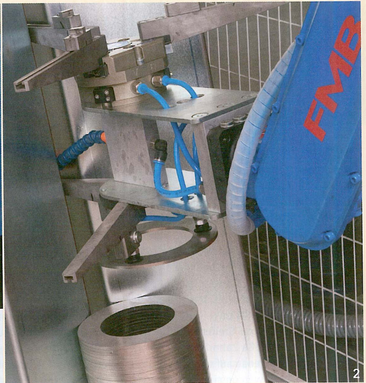
1 Roboterautomatisierte Drehzelle für die mannlose Komplettbearbeitung. 2 Damit der Wechselgreifer alle Dichtungsringgrößen prozesssicher hält, erledigen drei Saugnapfe die Erstaufnahme.
