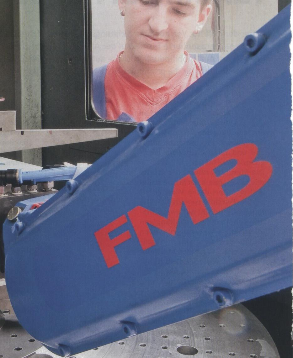
Rüstzeiten wie beim Formel 1 Boxenstopp: Für einen Greiferwechsel muss der Einrichter lediglich eine Schraube lösen. Die Luftversorgung ist integriert. Die Greifer wie auch die Werkstückwendeinheit lassen sich mit wenigen Handgriffen auf den geforderten Dichtungsdurchmesser einstellen.
