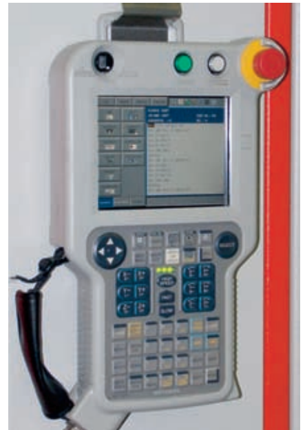
Die Automationszelle wird im Teach-In-Verfahren programmiert. Die Programmparameter und der Programmablauf werden durch ein TFT-Display angezeigt. (Bilder: FMB)
