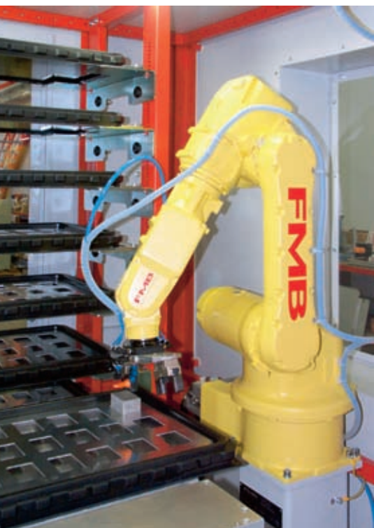
Bei der Automationszelle Unirobot-XP sorgt ein integrierter Palettenwechsler für das Handling der Werkstückträger.
