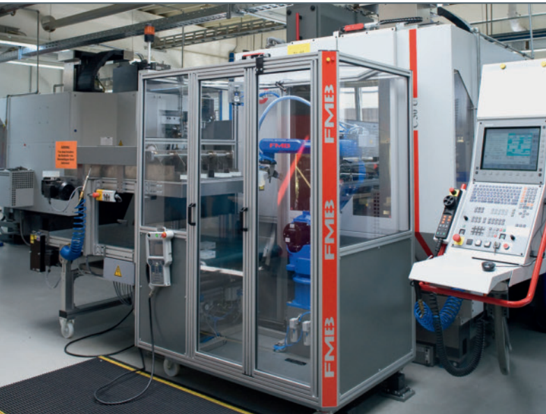
2 Kompakt und mobil: Bei Bedarf ist der Bearbeitungsraum frei zugänglich. Alternativ lässt sich die umhauste Automationszelle auch an anderen BAZ via Bodenanker präzise reproduzierbar andocken
