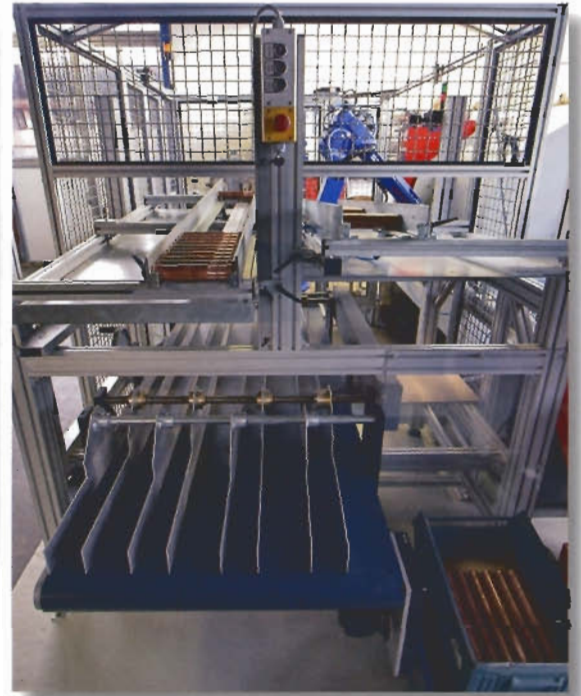
Bild 4 und 5: Suttner orderte bei FMB eine Materialzu- und abführung, die sowohl unterschiedlich große Wellen-, als auch Einlegeteile verarbeiten kann. Die Be- und Entladezone ist für den Bediener bequem und sicher. Und auch hier gelingt das Umrüsten auf neue Teile mit wenigen Handgriffen
