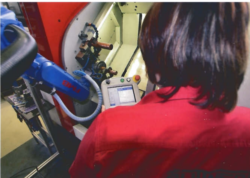
Bild 2: Die Programmierung ist schnell erlernt. Die Greifer sind über ein Schnellwechselsystem adaptiert. Ist ein Auftrag einmal eingefahren, gelingt das Umrüsten innerhalb von 10-15 Minuten
