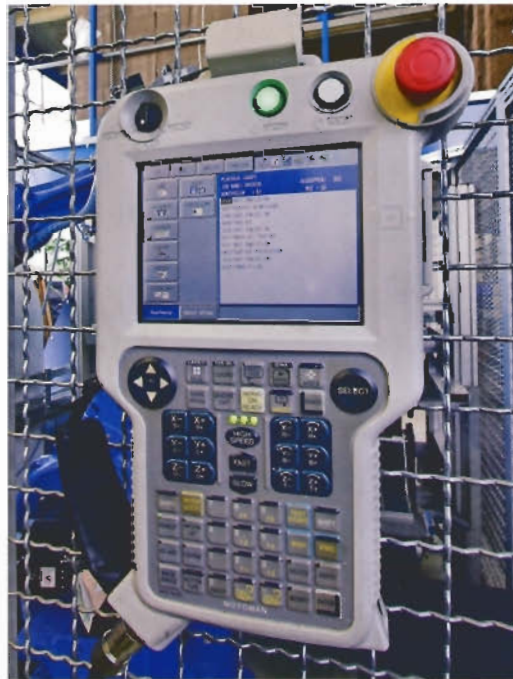
Bild 3: Das Bedientableau der FMB unirobot ist leicht und handlich. Programmiert wird komfortabel im Teach-In-Verfahren. Der Programmspeicher reicht für etwa 50 Werkstücke. Programmparameter und Programmablauf werden durch ein hochwertiges TFT-Farbdisplay visualisiert
