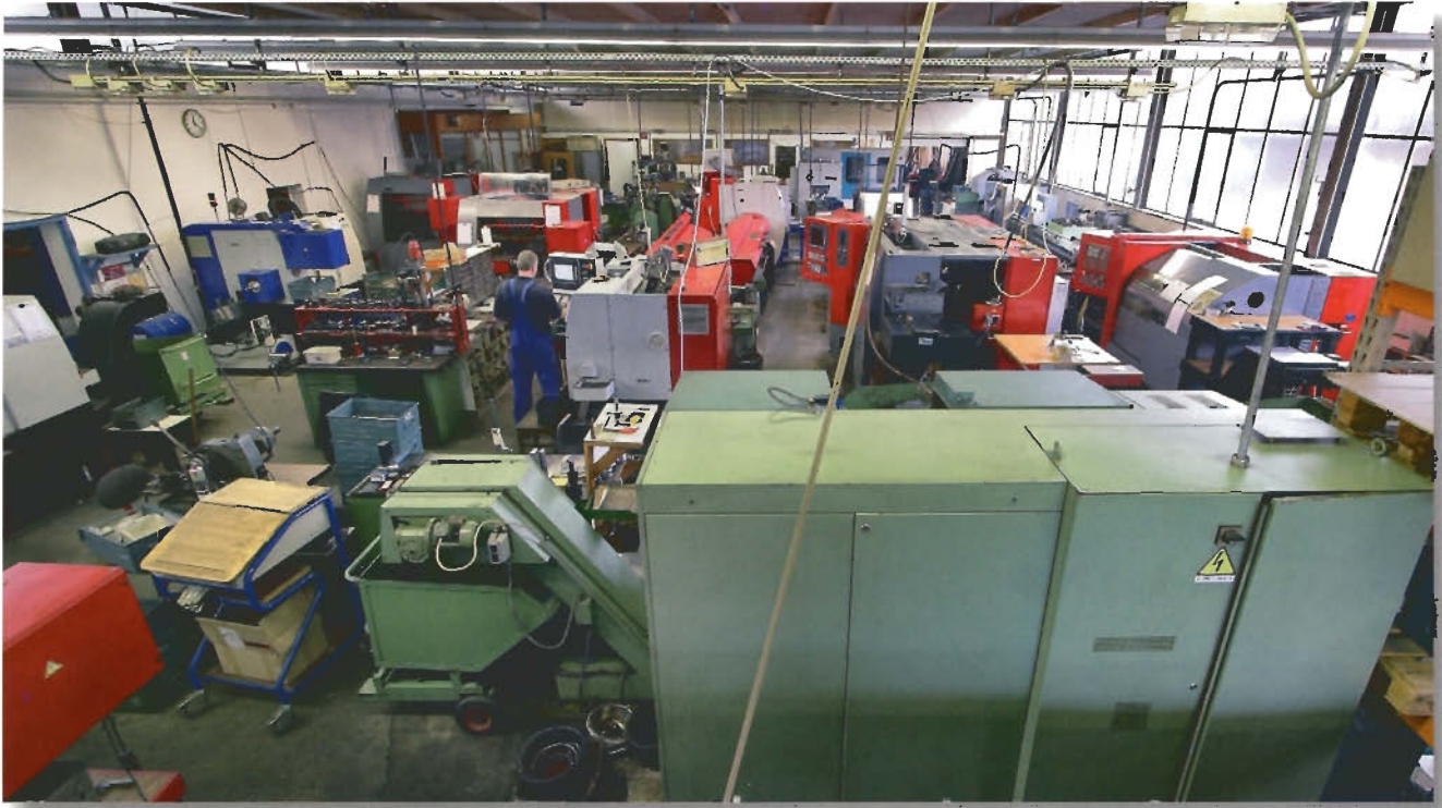
Bild 1: Das Suttner Fertigungsspektrum umfasst rund 3000 verschiedene Teile. Die Abmessungen gehen von M2 x 10 mm bis Ø 300 mm x 700 mm Länge. Ob Titan, Hasteloy, Inconell, VA-Stähle....., Suttner zerspannt was in die Drehspindel kommt
