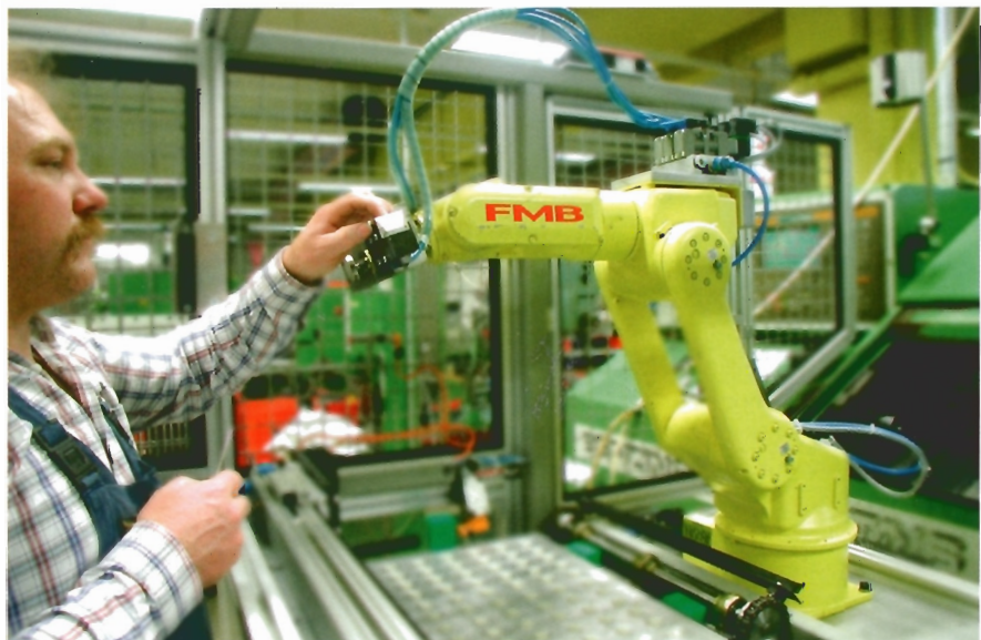
■ Produktivitätssprung: Durch die Adaption eines »Unirobot« an einer 13 Jahre alten Benzinger-Drehmaschine erhöhte Fresenius Medical Care in Schweinfurt die Produktionskapazität um 30 Prozent
