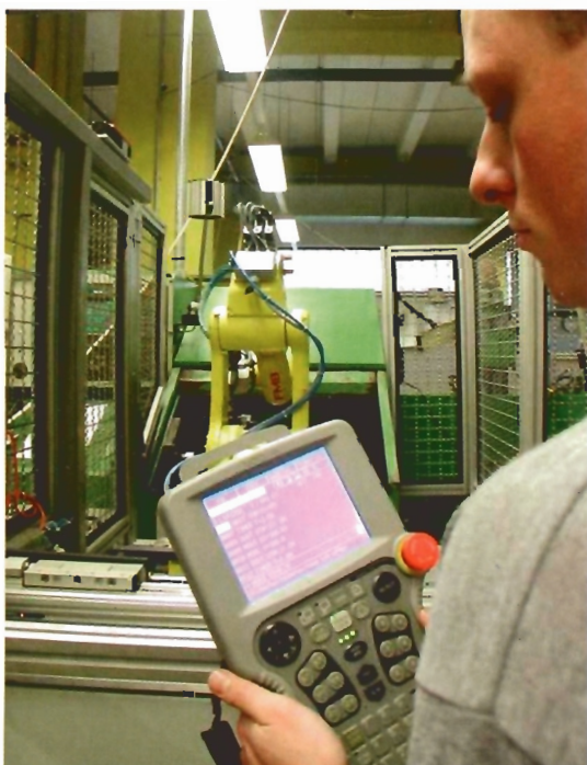
6 Easy-to-use: Das Bedientableau des Roboters ist abnehmbar und bei einem Gewicht von 1 kg recht handlich; programmiert wird im Teach-in-Verfahren
