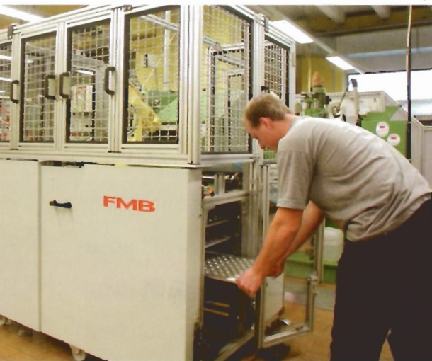
5 Unermüdetes Gespann: Dank geschickter Auftragsplanung sowie einem Teilevorrat aus acht Paletten be- und entlädt der Roboter fast regelmäßig mannlos in die dritte Schicht hinein
