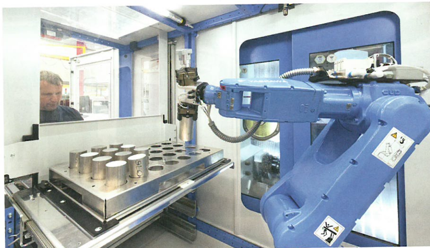
4 Großer Vorrat für bedienerlosen Betrieb über lange Zeiträume: In der Roboterzelle stehen mehrere Paletten für Rohlinge und komplett bearbeitete Bauteile bereit (Bild: Hennecke)
