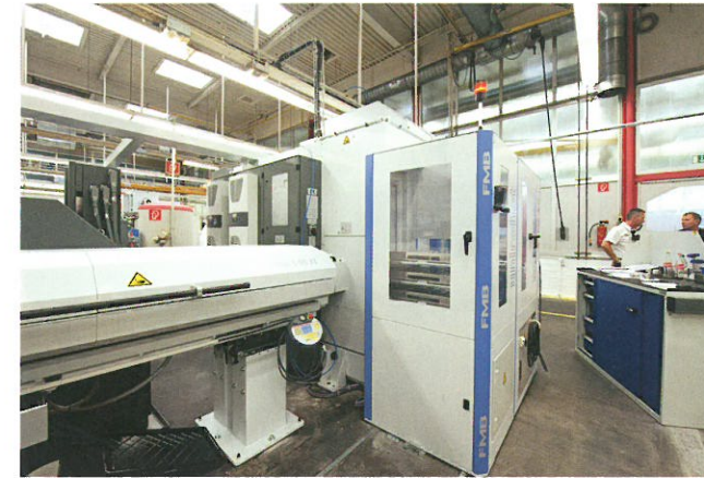
2 Automatisierung für flexiblen Wechsel: Abhängig von den zu fertigenden Werkstücken führt der Stangenlader oder der Roboter Rohlinge zu (Bild: Hennecke)
