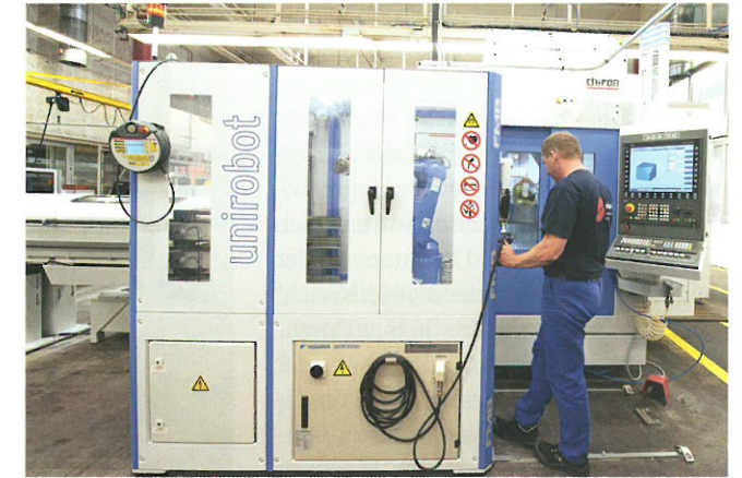
3 Auf Einzelstücke programmiert: Die seitlich verschiebbare Roboterzelle unirobot von FMB belädt das Bearbeitungszentrum mit Abschnitten und entlädt kubische sowie schlanke rotationssymmetrische Werkstücke (Bild: Hennecke)
