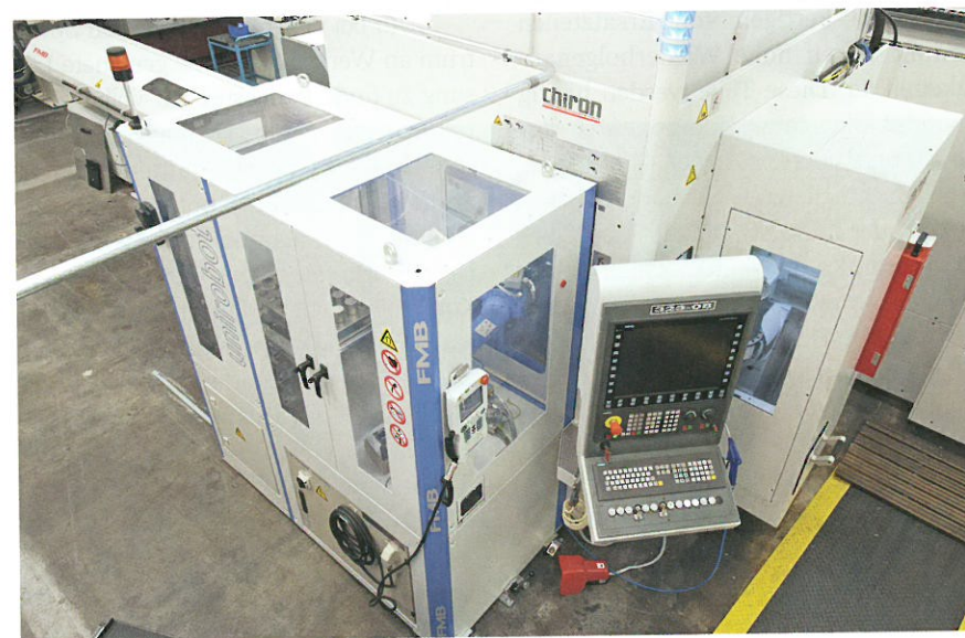
5 Kompakt und flexibel: Die gelungene Kombination der Roboterzelle mit dem Dreh- Fräszentrum sorgt für höchste Produktivität und Flexibilität beim Komplettbearbeiten kubischer und rotationssymmetrischer Bauteile (Bild: Hennecke)
