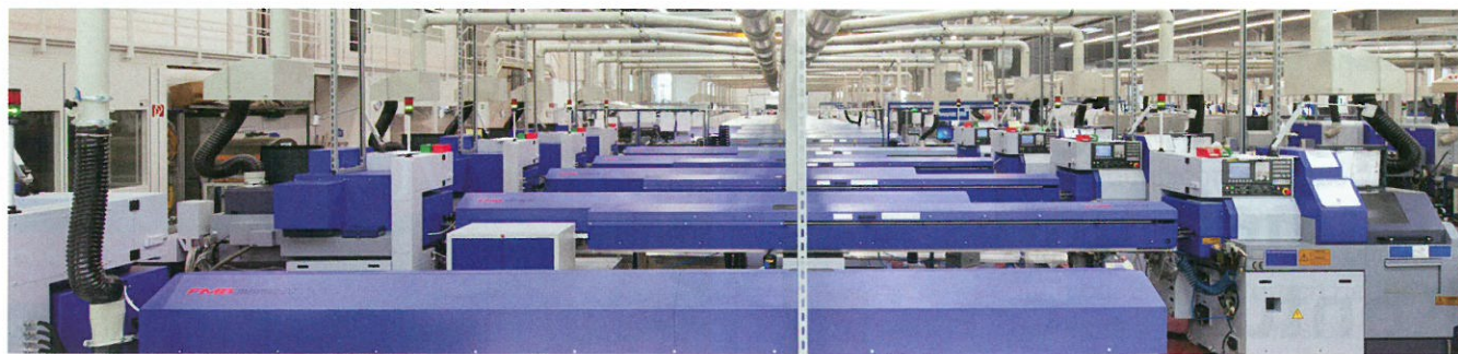
Bild 1: Bei der Leibold & Amann GmbH sind von den gut 175 CNC-Mehrspindel-, Kurz- und Langdrehern derzeit 118 mit unterschiedlichsten Lademagazinen der FMB Maschinenbaugesellschaft mbH, Faulbach automatisiert
