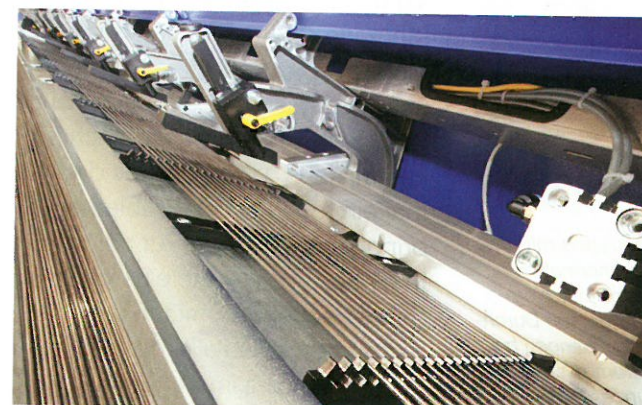
Bild 4: Durch Pilgerschrittvereinzeln kann zum Beispiel das Lademagazin FMB micromag Stangen ab 0,8 mm Durchmesser prozesssicher zuführen
